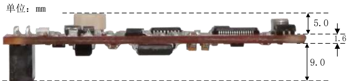
图 1.5 HART 模块正反面高度尺寸图
